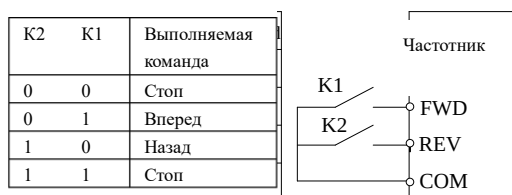
Рис.6-13 Двухпроводной режим управления 1
